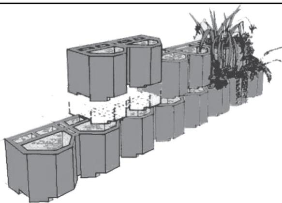
Colorato nella massa con i pigmenti minerali, fabbricato con una formula di calcestruzzo minuziosamente elaborata, una forza di serraggio che garantisce una forte resistenza meccanica. Colore scelto: quello delle rocce proprie a ciascuna regione. Altezza massima: 2.40 m a seconda del terreno senza carichi a monte.
